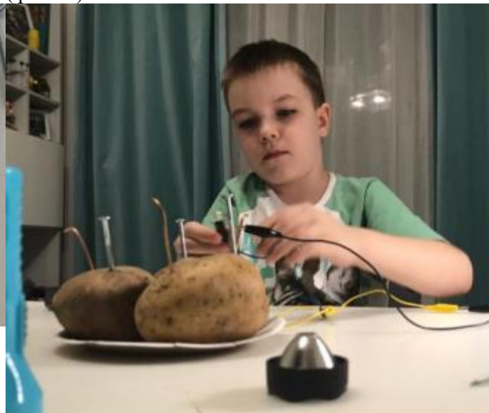
Соединение картофельной батареи (фото 4)
